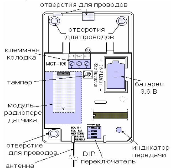
Рисунок 1. МСТ-100 со снятой крышкой
