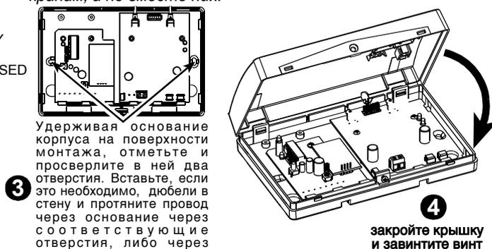
Удерживая основание корпуса на поверхности монтажа, отметьте и просверлите в ней два отверстия. Вставьте, если это необходимо, дюбели в стену и протяните провод через основание через соответствующие отверстия, либо через ответствие, закрытое отламываемой пластиной. Прикрепите основание корпуса к стене двумя шурупами.
