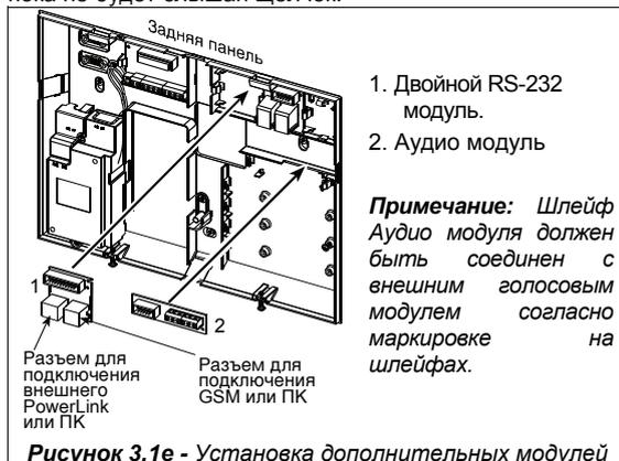
Рисунок 3.1e - Установка дополнительных модулей
