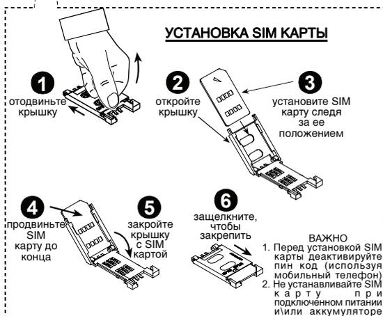
Рисунок 3.1j – Установка GSM/GPRS модуля
