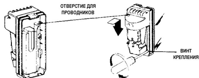
4. Подключите проводники к контактам (См. Подключение). Затяните не использованные винты контактов.
