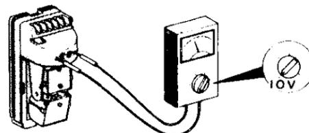
При горизонтальной настройке поворачивайте зеркало для достижения максимального напряжения.
