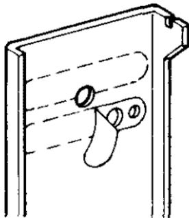
2. Установите кронштейн на столб и надежно закрепите его скобами и монтажными винтами.
