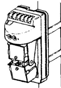
Если монтируются два блока на одном столбе, то можно использовать разные пары монтажных отверстий кронштейна. Это позволит установить блоки на одинаковой высоте.
