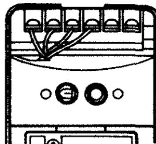
5. После произведения оптической настройки и проверки работы (См. Разделы 5 и 7), закройте крышку и заверните винт.
