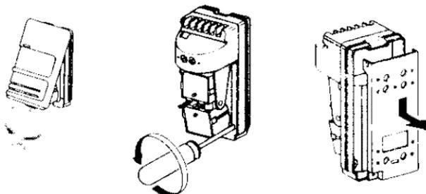
2. Закрепите кронштейн на стене монтажными винтами. Выведите проводники через отверстие в кронштейне.
