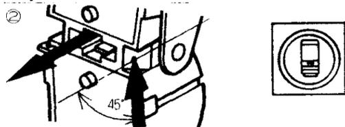
Смотрите в любое из отверстий прицела под углом 45°. Поворачивайте зеркало вокруг горизонтальной оси пока не будет виден второй блок в центре кругов прицела.
